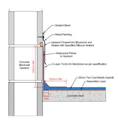
**BLOCKWALL TORCH-ON UPSTAND DETAIL**
