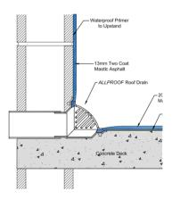
**BLOCKWALL PARAPET OUTLET DETAIL**
